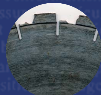
Rupture des segments
