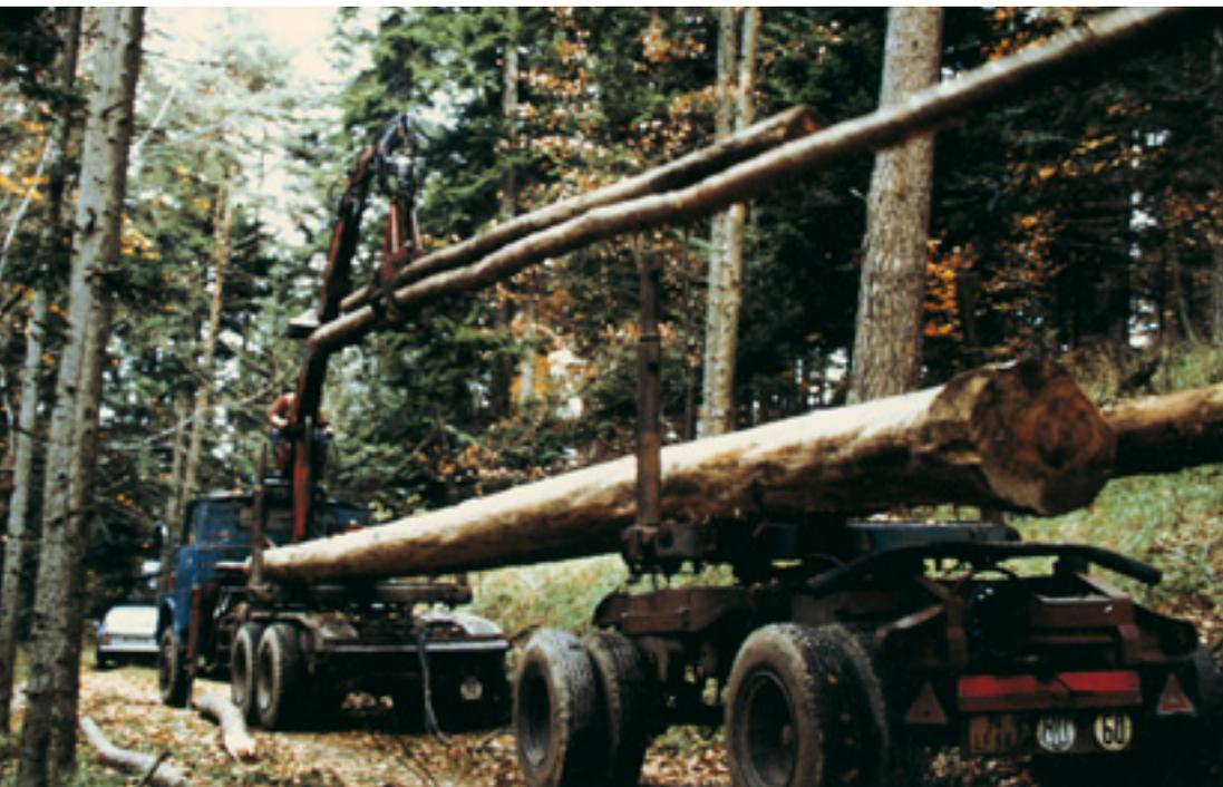
En principe, on utilise des véhicules à carrosserie normale, à plateau, à ridelles, à plateau sans ridelles, à plateau avec ranchers.
