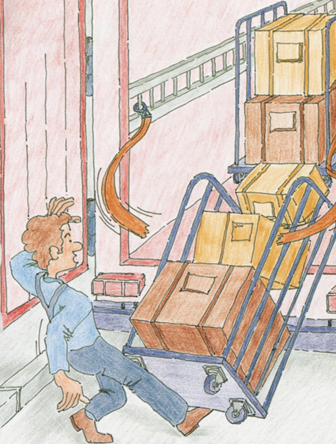
■ **3.** Tendre sans excès les dispositifs d'amarrage (câbles, sangles...) et les protéger contre les arêtes vives ou coupantes par des équerres ou des fourreaux adaptés. Le rayon de courbure imposé aux sangles doit être supérieur ou égal à leur épaisseur.
