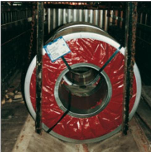
de la remorque, utiliser une cinquième sangle qui enveloppe la bobine et maintient les autres sangles au-dessus du niveau de l'axe de la bobine (figure 7).
