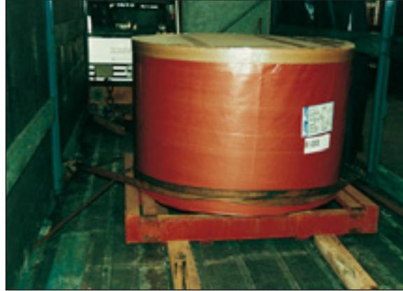
insuffisantes vis-à-vis des efforts longitudinaux. De plus, les sangles positionnées en partie basse ont un dimensionnement insuffisant et n'immobilisent pas la bobine dans le sens vertical.
