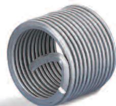
Le filet rapporté est réalisé à partir d'un fil laminé en section losange. On obtient ainsi deux filetages concentriques de haute précision et en l'occurrence un taraudage interne ajustable et utilisable des deux côtés.
