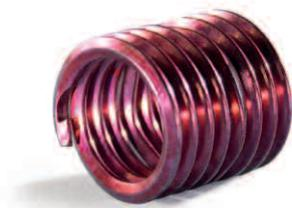
L'HELICOIL® Tangfree Screwlock comporte les mêmes avantages que l'HELICOIL® Tangfree Free Running avec en plus un système de freinage interne qui s'oppose au dévissage de la vis. Ce freinage est obtenu grâce à une ou plusieurs spires polygonales qui provoquent un serrage important sur les flancs du filet. Le couple de serrage et le couple de freinage obtenus avec des filets HELICOIL® Tangfree Screwlock sont conformes aux normes ISO 2320.
