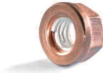
L'écrou frein haute performance HELICOIL® se compose d'un corps d'écrou assemblé avec un filet rapporté HELICOIL® Plus Screwlock. La fonction anti-dévissage est assurée par la ou les spires déformées de l'HELICOIL®. Ces spires vont se déformer de façon élastique et réversible au moment du vissage. Le couple de freinage ainsi obtenu est conforme aux exigences de la norme ISO 2320. La gamme est disponible dans différents matériaux.
