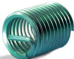
Le filet rapporté est réalisé à partir d'un fil laminé en section losange. On obtient ainsi deux filetages concentriques de haute précision et en l'occurrence un taraudage interne ajustable et utilisable des deux côtés.
