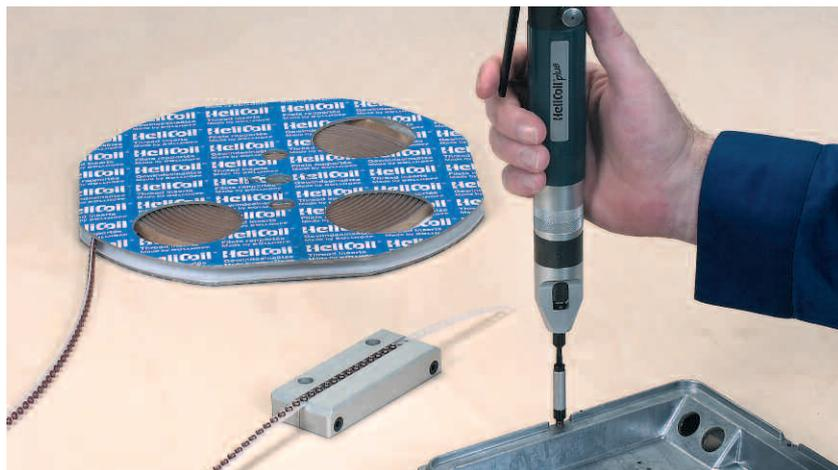
Pose d'un HELICOIL® Plus
