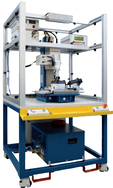
Machine de pose thermique par soudage par résistance électromagnétique ERW, pour l'assemblage d'inserts dans un moteur de voiture
