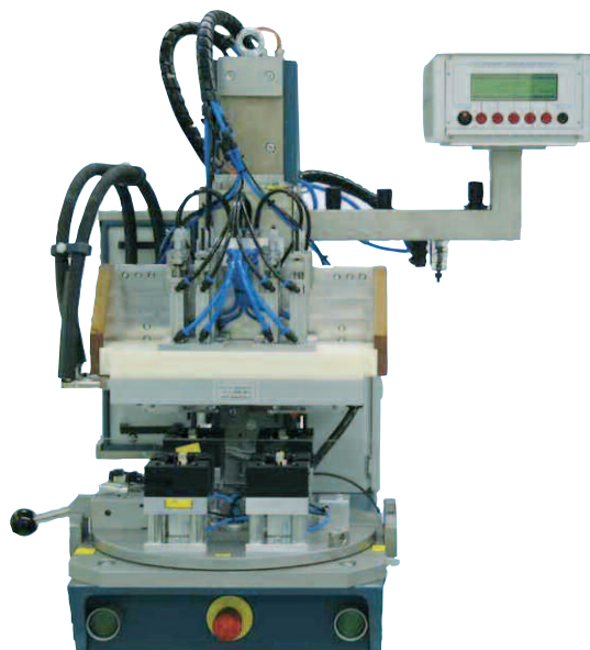
Machine de pose thermique par soudage par résistance électromagnétique ERW, pour l'assemblage de huit inserts M1.6 dans une coque de téléphone portable
