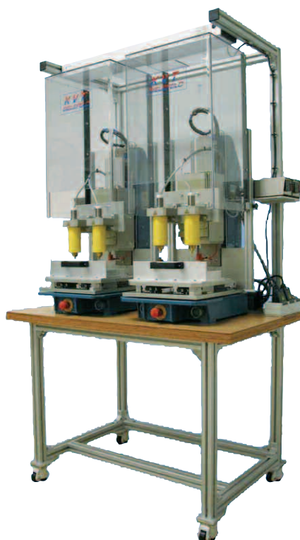
Machine de pose thermique KVT basic 5000 DUO, conçue pour assembler simultanément quatre inserts dans deux boîtiers de rétroviseurs
