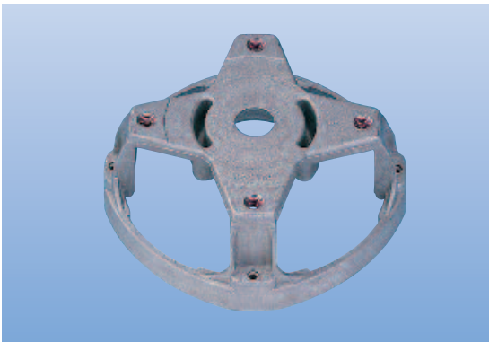
Flasque de moteur d'un broyeur en aluminium pour le jardinage Sécurité contre le dévissage assuré par HELICOIL® plus SCREWLOCK® M 8 x 12
