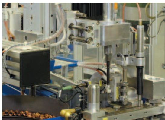
Pose automatique HELICOIL® plus M 8 SCREWLOCK® .
